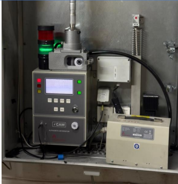
AS A.L.A.R.A teise tuumareaktori kiirgusohutuse jälgimisseadmed. Foto: Lasse Richard Sissase erakogu
